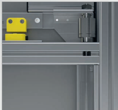
Schutz vor Verunreinigung durch Einbau des Zylinders im Alu-Kabelkanal. Protection against soiling due to installation of cylinder in aluminum cable channel.
